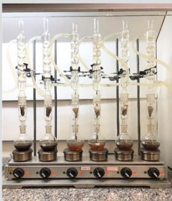
Extração de Asfaltenos
