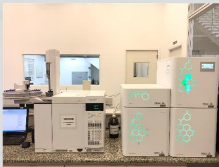
Cromatografia Gasosa (SIMDIS)
